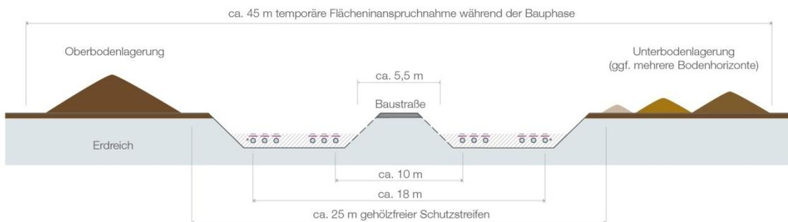
**Abbildung 7: Regelgrabenprofil 380-kV-Kabelgraben**
