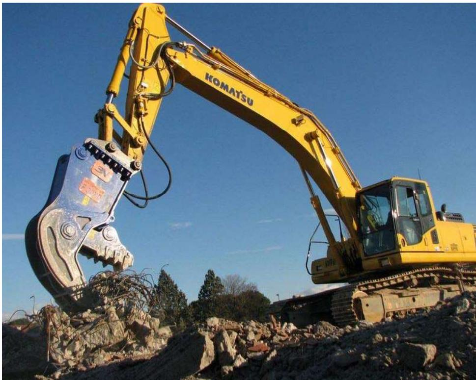
*Abbildung 2.1: Bagger mit Abbruchzange (Pulverisierer)*
