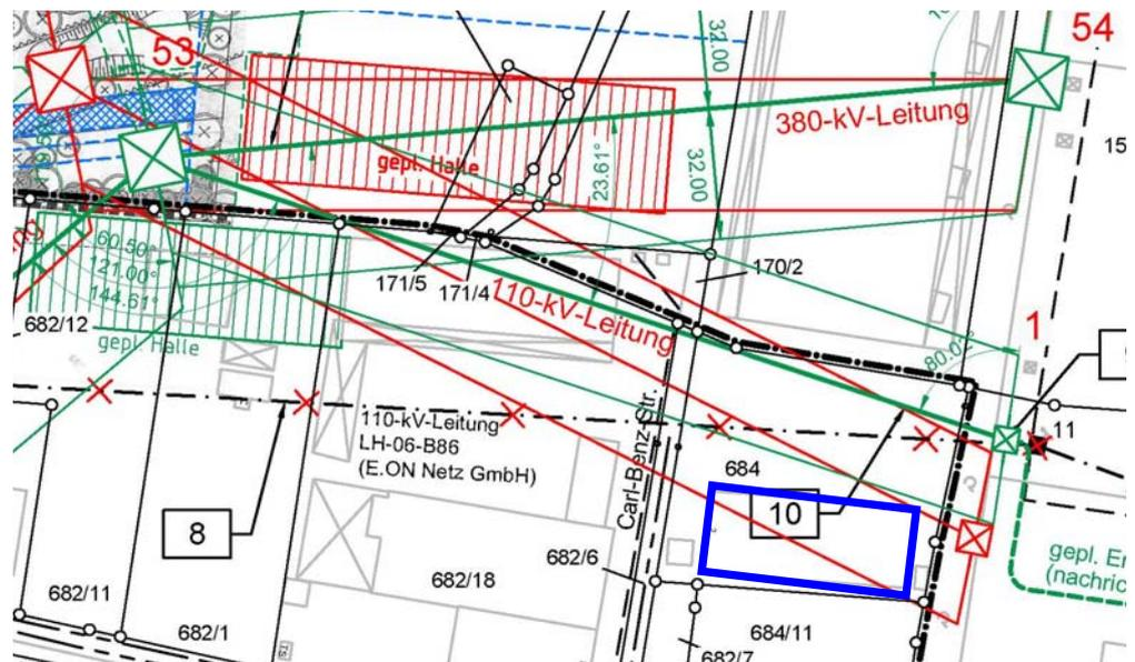
Abbildung 3: Beantragter und tektierter Maststandort Nr. 1 (110kV)
