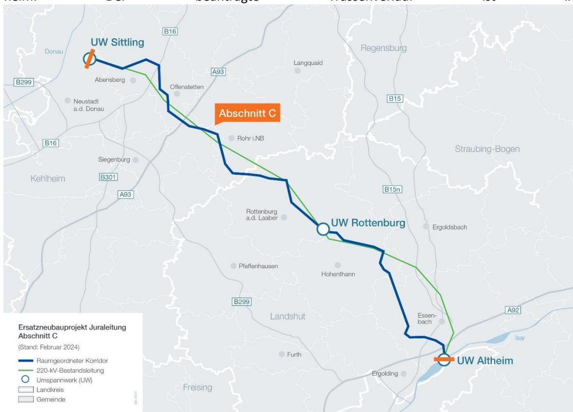
Abbildung 3: Schaubild Teilabschnitt Alheim – Sittling - Sittling in blau dargestellt. Die bestehende 220-kV-Leitung wird mit dem Bau der neuen Leitung zurückgebaut.
